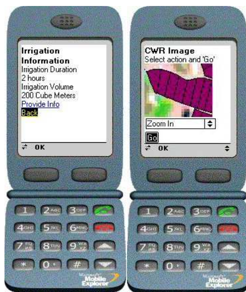
Fig.8 Terminale di nuova generazione per la distribuzione dei consigli irrigui forniti dal prototipo DEMETER agli agricoltori.
