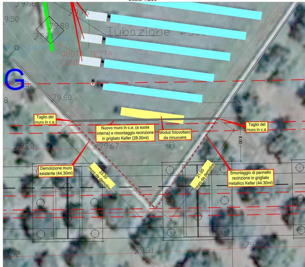
**PARTICOLARE SPOSTAMENTO MODULI FOTOVOLTAICI ED IMPIANTI ANNESSI**
