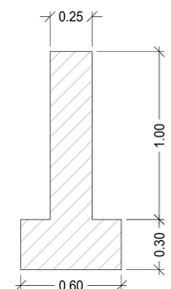
**SEZIONE DEL NUOVO MURO A SUOLA INTERNA (28.00ml)**
