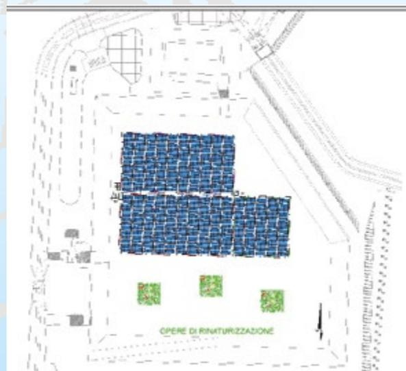
Realizzazione impianto fotovoltaico galleggiante sul bacino di compenso «Boscariello» per una potenza totale pari a 559,00kW
