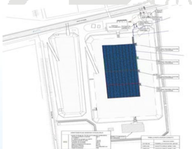
Realizzazione impianto fotovoltaico galleggiante sul bacino di compenso «Corno D'Or o» per una potenza totale pari a 894,40kWp
